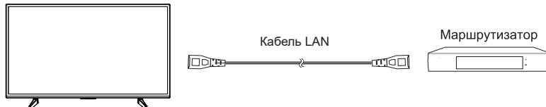
Подключите кабель LAN со штекером RJ-45 к разъему LAN на задней стороне телевизора. Это необходимо для работы SMART режима ТВ в режиме проводной интернет-сети.
