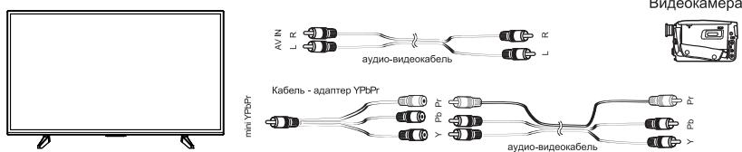
Подключите видеокамеру к телевизору, используя кабель-адаптер YPbPr (для видео) и аудиокабель 2xRCA «тюльпан» (кабель-адаптер mini YPbPr 3,5mm - YPbPr и аудиокабель 2xRCA «тюльпан» в комплект поставки не входят).
