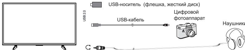
Разъем для подключения USB-устройства телевизора становится активным только в режиме USB.
